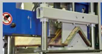
Behringer band saw with carbide kit Behringer Bandsäge mit HM-Paket
