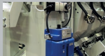
Punches lubrication for extended tooling lifetime Stempelschmierung für erhöhte Lebensdauer
