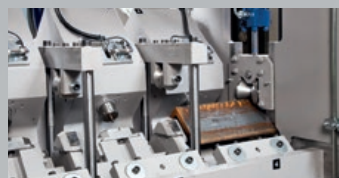
VP-X 166 with separate one-piece punching units - VP-X 166 mit getrennten einteiligen Stanzeinheiten
