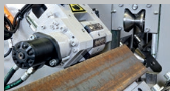
High speed marking barrel marking unit Hochgeschwindigkeits-Markiereinheit mit Trommel
