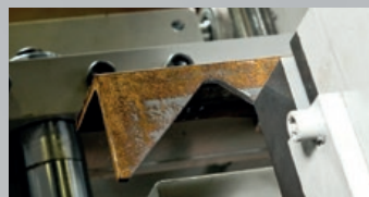
Notching unit with 45° angle shape Ausklinkeinheit mit 45° Gehrungsschnitten
