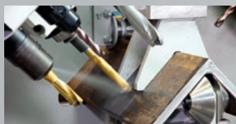
Drill units above the angle: easy collection of chips and coolant - Bohreinheiten über dem Winkelprofil: einfache Späne- und Kühlmittelabfuhr
