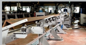
Tilting loading arms for lighter angles Kippvorrichtungen zum Leichtwinkelbeladen auf Zufuhrbahn
