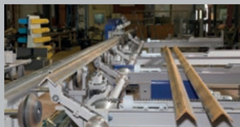
Storage chains and rotating arms Kettenförderer und Dreharmlen zum Aufladen
