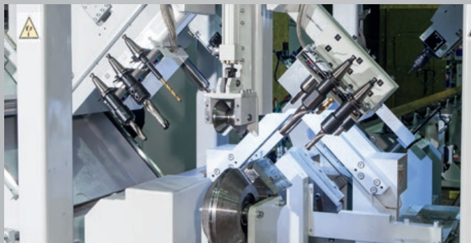
Tool changer 6 positions per spindle and CNC controlled clamps position Werkzeugwechsler mit 6 Positionen auf jeder Spindel und CNC-gesteuerte Niederhalterposition
