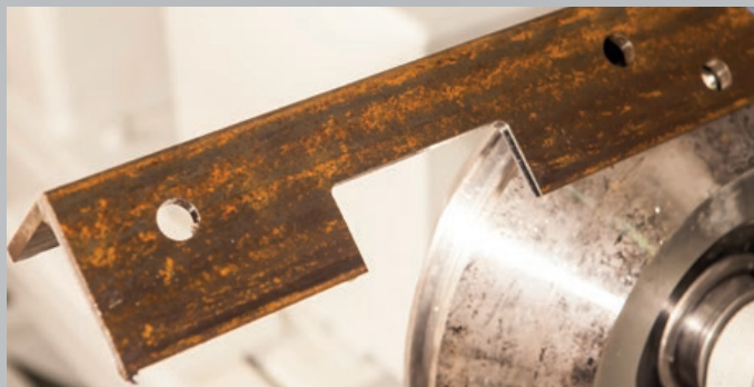
Notching by milling Ausklinden durch Fräsen
