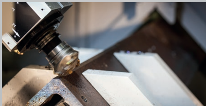
High speed heel milling Hochgeschwindigkeits-Kantenfräsen
