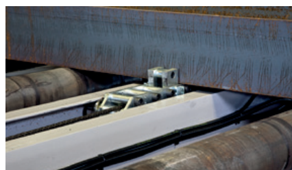
Ripeur de chargement à doigt escamotable Loading chain with retractable finger Kettenförderer mit einziehbarer Nocke
