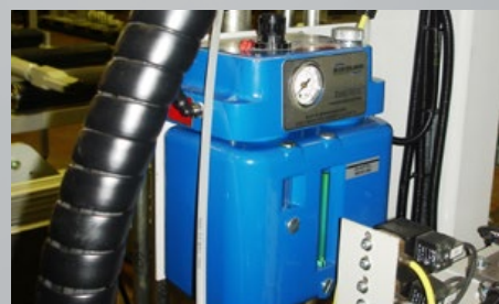
Punches lubrication for extended tooling lifetime Stempelschmierung für erhöhte Lebensdauer
